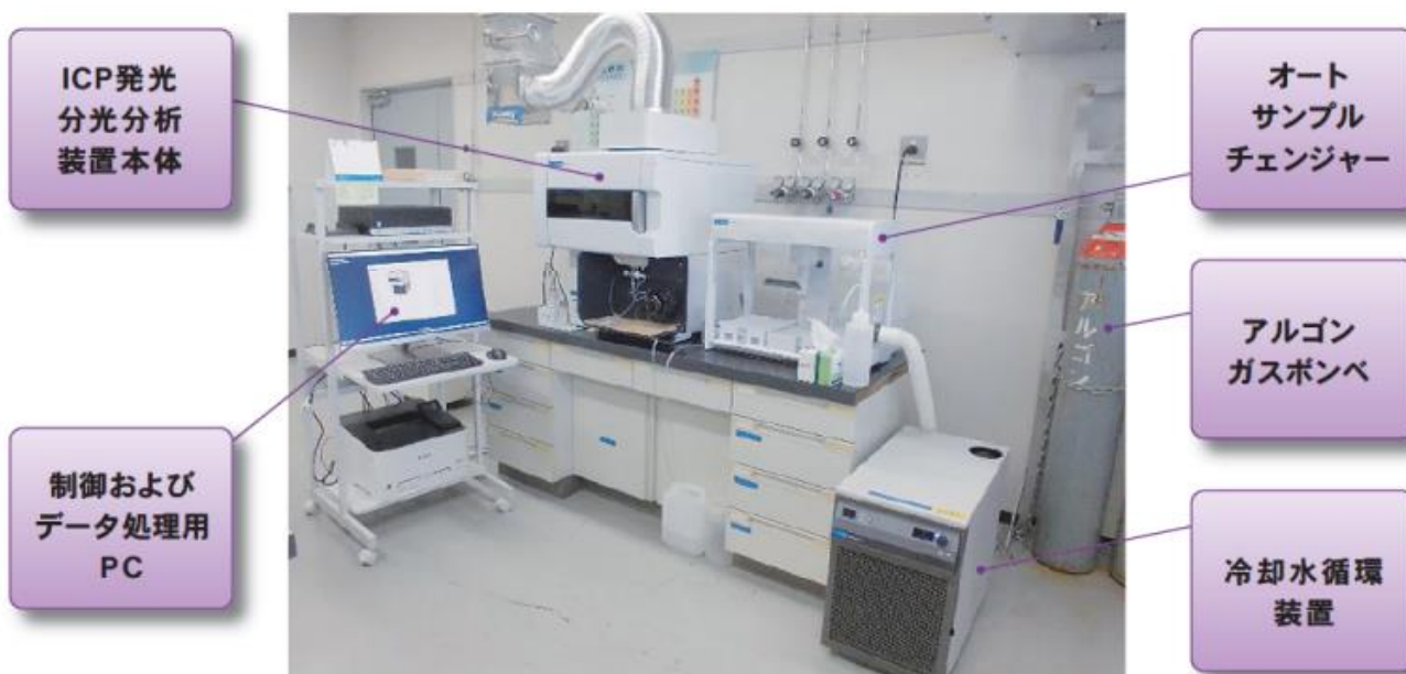
ICP発光分光分析装置(アジレント・テクノロジー 5800ICP-OES)
