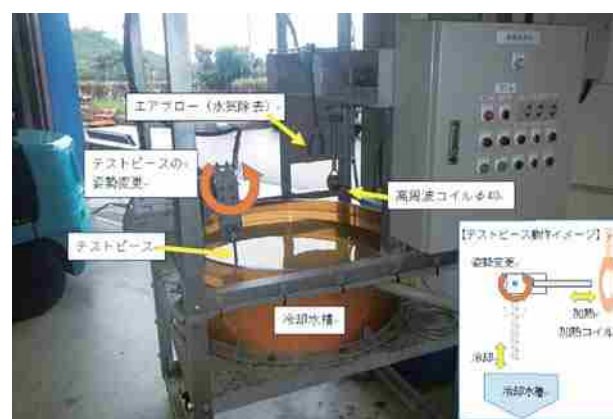
図3 熱サイクル試験機の外観
