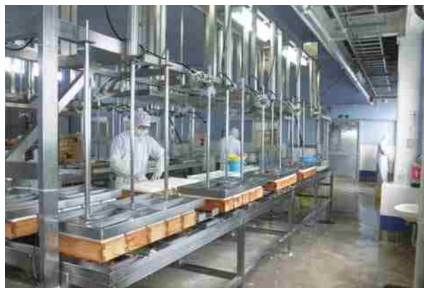
なかむら食品の沖縄式豆腐製造ライン
