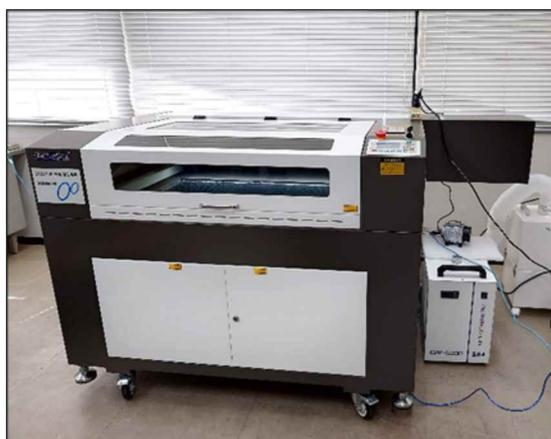
■切断用小型レーザー加工機「Cut-Key900N」
