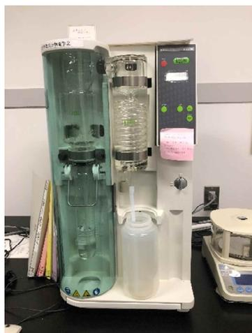
図2 水蒸気蒸留装置
