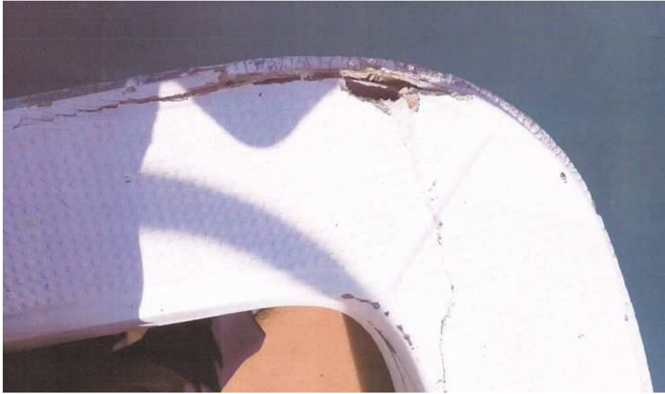
台風による漁船被害状況（本体右舷後方側破損）（平成30年10月撮影）
