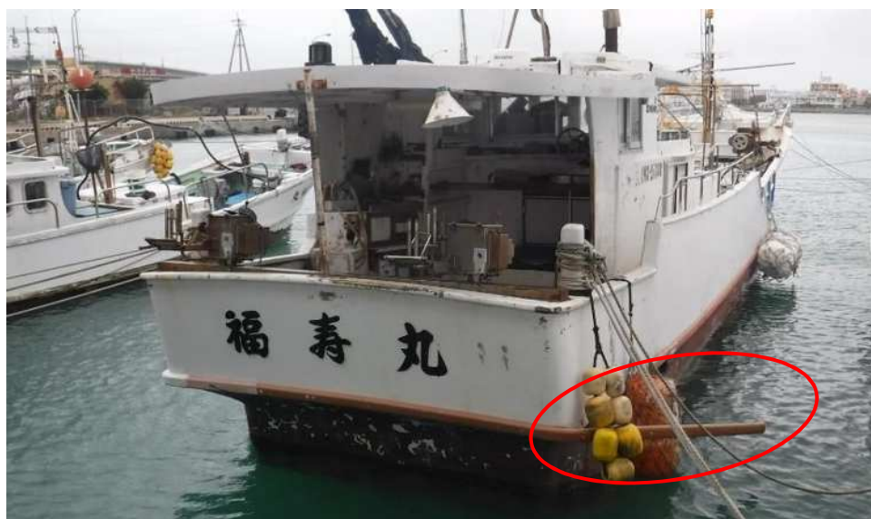
台風による漁船被害状況（右舷ラブレール破損）（平成30年10月撮影）
