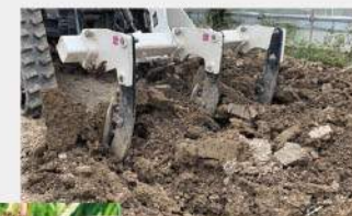
排土型 心土破碎機 例: プラソイラ
