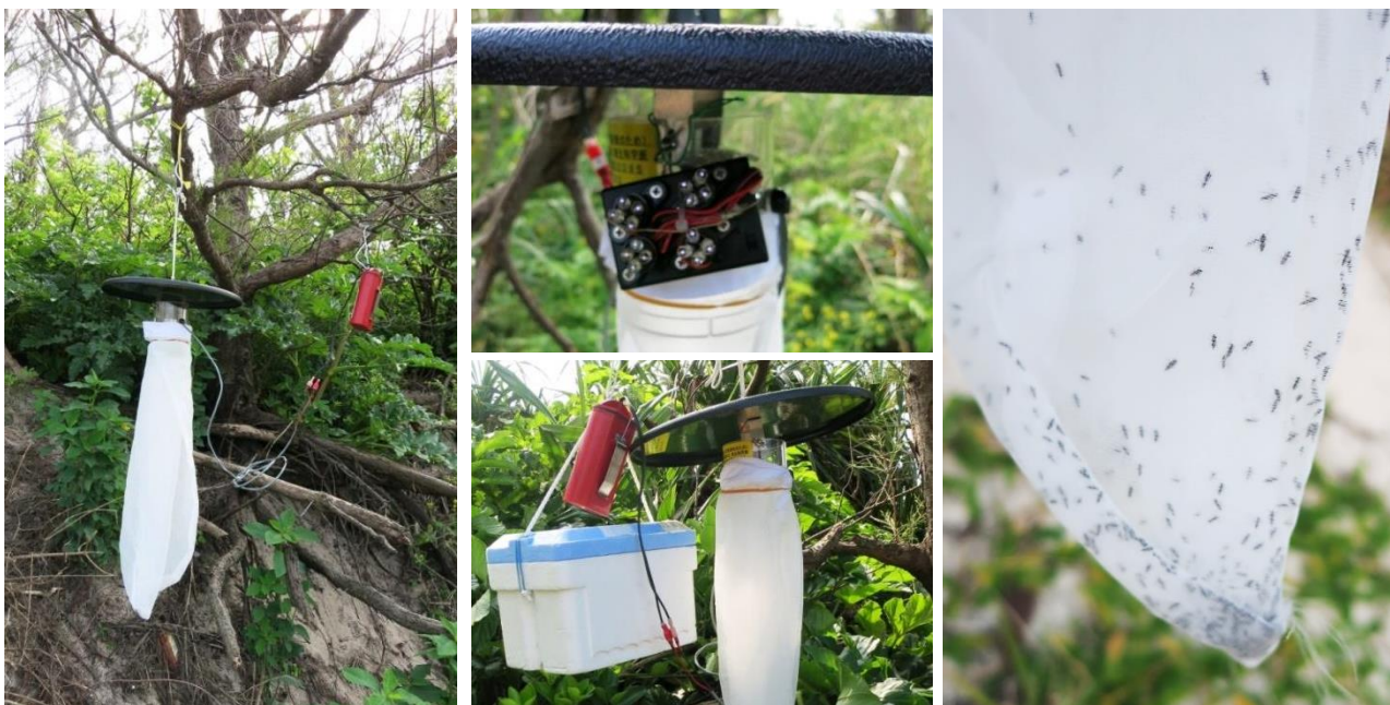
図2. 久米島シンリ浜で実施したCDC型ミニチュアライトトラップによるアーサ虫誘引試験の画像(1). 左: ライトなし区トラップ設置図(地点A), 中央上: UV区で使用したLED UVライト, 中央下: ドライアイス区でトラップと併用したドライアイス入り発泡スチロール, 右: 捕虫網内に捕獲されたアーサ虫
