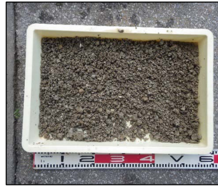
図-2.4.8 試験に使用した軽石の外観
