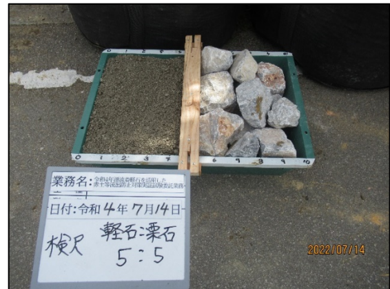
図-2.4.10 籠内の詰め材料 (軽石・栗石=5:5)(宜野座村)
